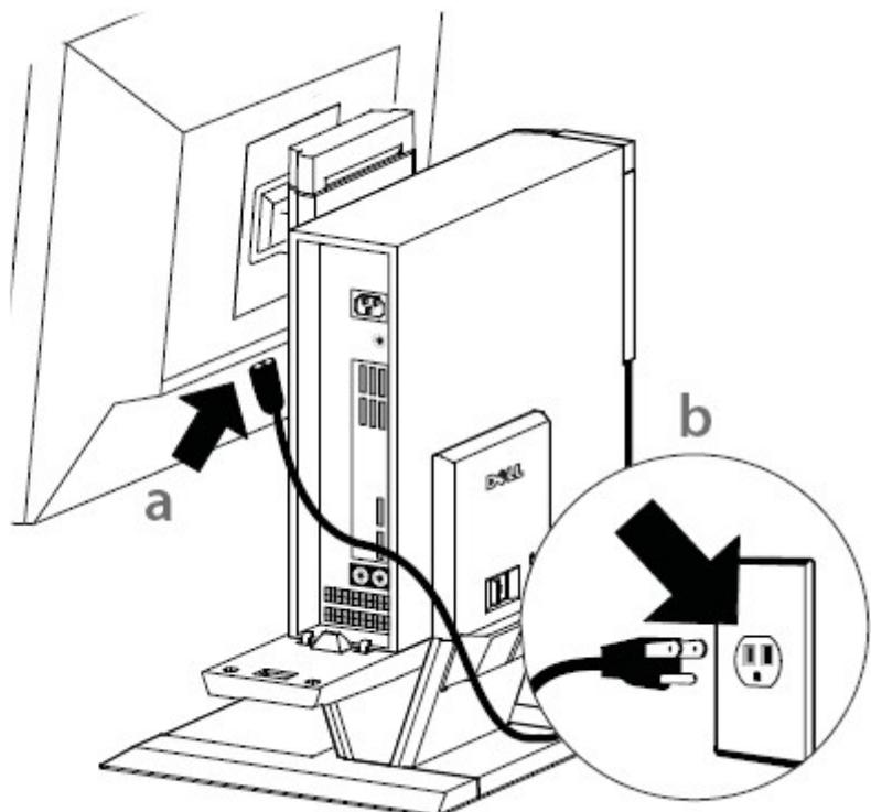
**8** a Conecte el cable de alimentación de sistema al equipo.
